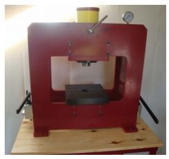
réaliser : Pompes hydrauliques, clapets, vérin, vanne de décharge et cuve d'huile, plutôt que de les acheter dans le commerce. J'ai naturellement été amené à concevoir et fabriquer des clapets d'aspiration et de refoulement capables d'être à la fois étanche à très basse pression < 0,1 bar aussi bien qu'à 300 bar sans se détériorer.
