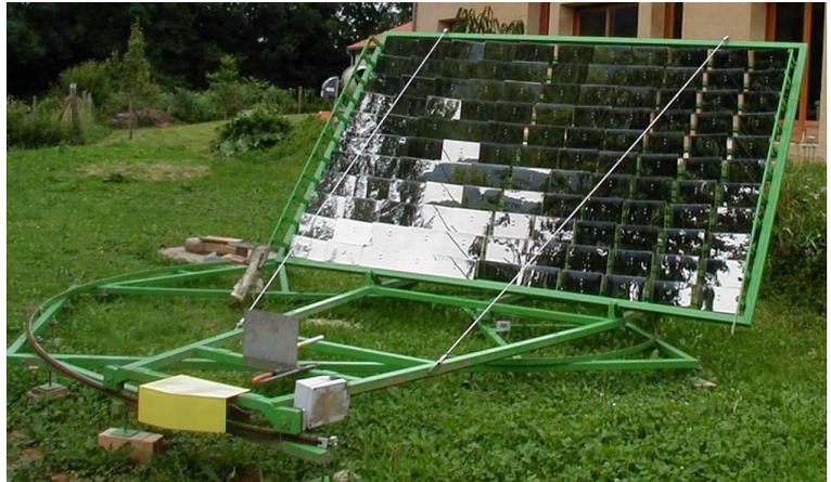
Le réglage des miroirs était délicat et la focalisation n'était optimum que pour une seule hauteur solaire. Elle se dispersait ensuite sur les côtés pour les autres hauteurs. En effet, lorsque la poursuite de hauteur solaire consiste à ne régler que l'angle de pivotement des barres, seul les miroirs situés proche du plan vertical central maintiennent leur pointage au foyer. Les miroirs des deux côtés de ce plan nécessitent un pilotage sur les deux axes pour maintenir leur pointage au foyer.
