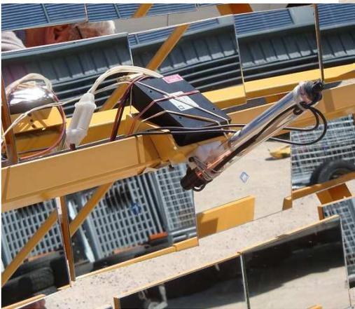
Afin de faciliter et d'affiner le réglage de pointage des miroirs, j'invente une seconde innovation consistant à déplacer sur chacun des miroirs un module laser restant toujours parallèle à lui même. Ce module coulisse sur une barre horizontale amovible qu'il est possible de placer en face chaque ligne de miroirs. La direction du faisceau laser est alors la même pour tous les miroirs comme les rayons du soleil au même instant.
